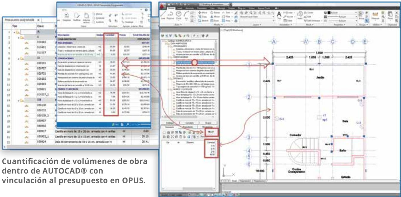
Cuantificación de volúmenes de obra dentro de AUTOCAD® con vinculación al presupuesto en OPUS.
